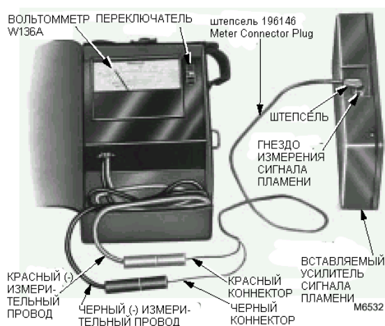
Рисунок 11. Измерение сигнала пламени в мкА
