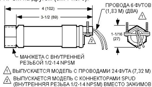
Рисунок 1. Установочные размеры C7027A, дюймы (мм)
